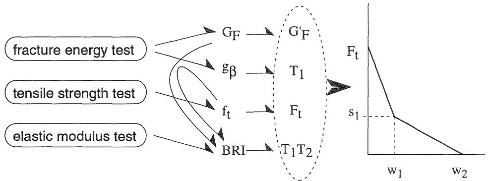
Fig. 2. Procedure to determine parameters
